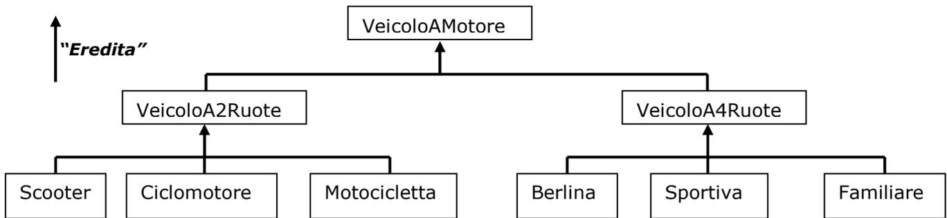
La classe *Motocicletta* è una **sottoclasse** della classe *VeicoloA2Ruote*; la classe *VeicoloA2Ruote* è **superclasse** della classe *Motocicletta* e **sottoclasse** della classe *VeicoloAMotore*.
