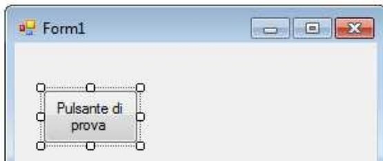
**N.B. Occorre non confondere la proprietà *Text* con la proprietà *Name*: sul pulsante appare il testo “Pulsante di prova”, tuttavia il nome dell’oggetto è rimasto *Button1* ed è proprio questo il nome che occorre utilizzare per identificarlo nel codice.**
